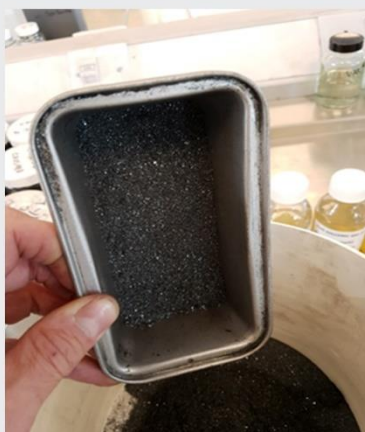
związane cząstki pyłu produktem RENOCLEAN AIR LOCK-DOWN po odparowaniu wody
